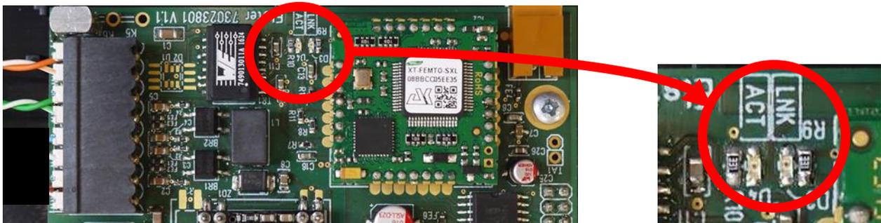
Abb. 22: Leuchtdioden „ACT“ und „LINK“ auf der iCE260-Ethernet-Schnittstelle
