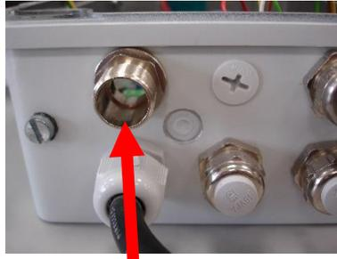
Abb. 17: Einschraubteil der EMV-Kabelverschraubung
