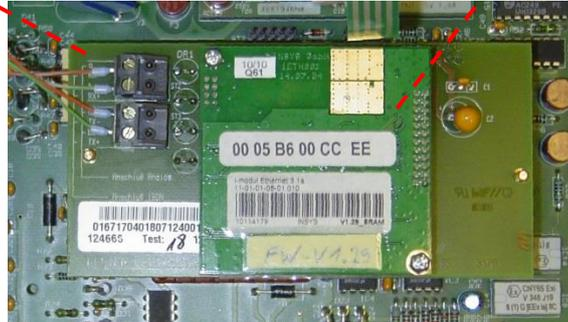
Abb. 14: Insys-Ethernet-Adapter in der FE260
