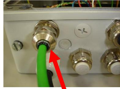
Abb. 18: Fertig montierte EMV-Kabelverschraubung
