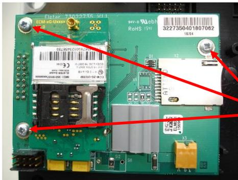
Befestigen Sie die Modem-Baugruppe an den drei gezeigten Positionen. Verwenden Sie dafür die mitgelieferten Plastide-Linsenschrauben 3x6.
