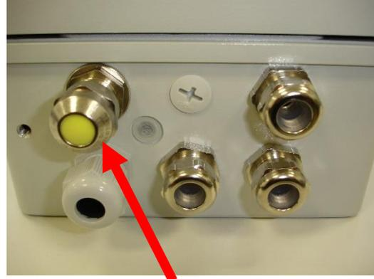
Abb. 15: Spezielle EMV-Kabelverschraubung für die Montage des Ethernetkabels
