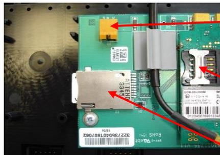
Anschluss für die Modem-Batterie **oder** das interne Netzteil
