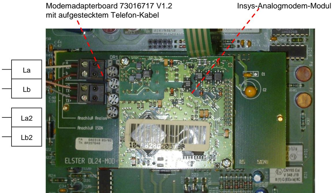
Abb. 13: Insys-Analogmodem in der FE260
