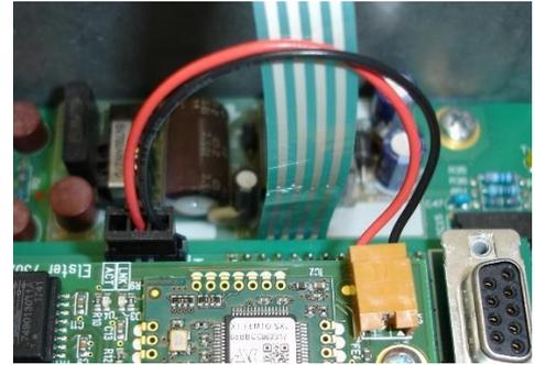
Abb. 20: Stromversorgung der Ethernet-Schnittstelle
