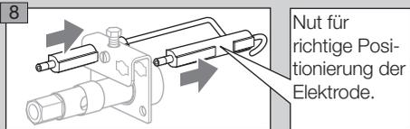
Nut für richtige Positionierung der Elektrode.
