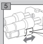
Der Luftschieber ist werkseitig geöffnet. Luftschieber nur schließen, wenn der Brenner nicht stabil brennt.
