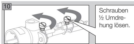
Schrauben  $\frac{1}{2}$  Umdrehung lösen.
