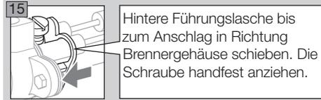
Hintere Führungslasche bis zum Anschlag in Richtung Brennergehäuse schieben. Die Schraube handfest anziehen.
