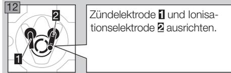
Zündelektrode 1 und Ionisationselektrode 2 ausrichten.
