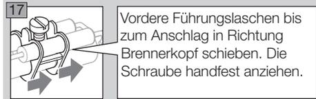
Vordere Führungslasche bis zum Anschlag in Richtung Brennerkopf schieben. Die Schraube handfest anziehen.
