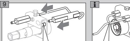
Beim Einschieben der Elektroden die Ausrichtung beachten.
